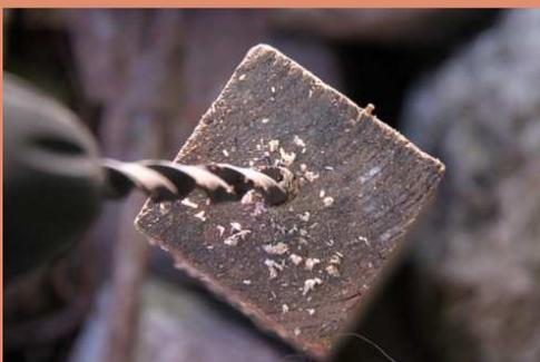
Mit einem kleineren Bohrer die „Hotelzimmer“ bohren.
